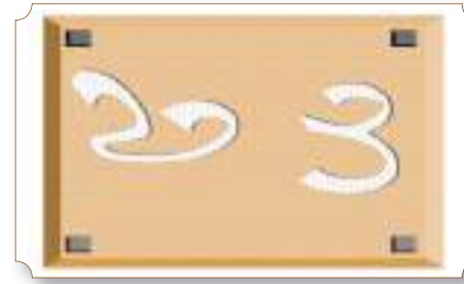
الشكل (١٣٠) تثبيت قطع مربعة من المطاط على أركان قطعة الخشب.
