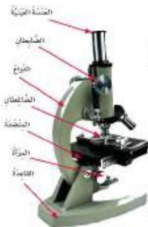
المجهر: أداة تستخدم مجموعة عدسات لتكبير الأشياء أو صورها لتبدو أكبر حجمًا. ويكبر المجهر الأشياء بنات أو آلاف المرات. أنظر لأن الشكل المجاور وتعرف أجزاء المجهر المختلفة.
